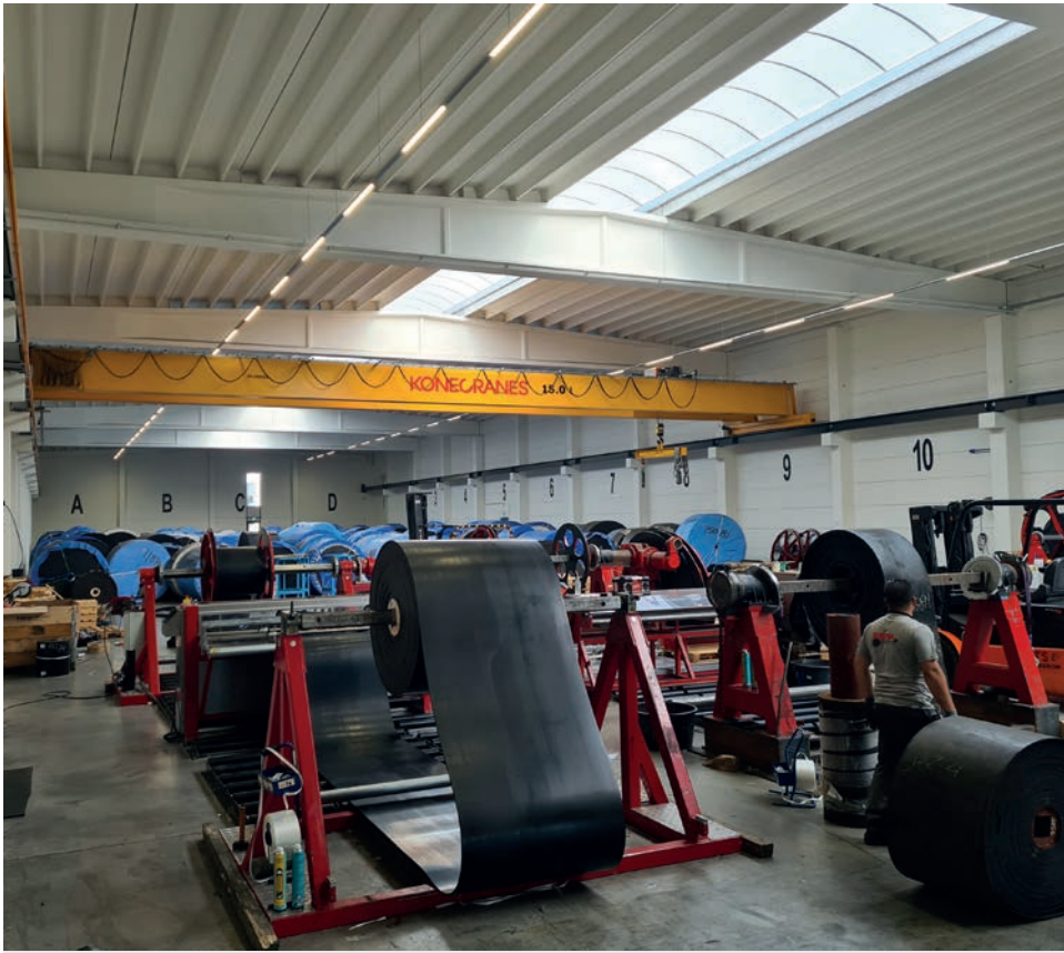
Afb. 2 Rubbersnij-afdeling voor het machinaal snijden van banden tot een breedte van 3500 mm
