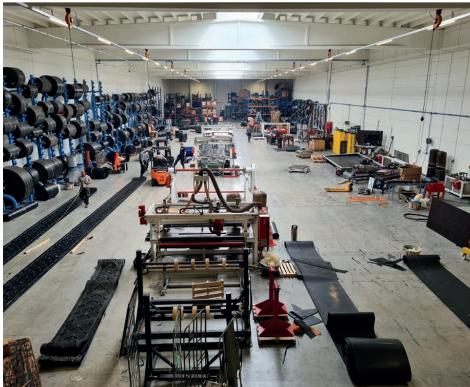
Afb. 1 Rubberconfectie-hal voor het warm vulkaniseren van transportbanden tot een breedte van 2200 mm, en een semi-automatische lijn voor het vulkaniseren van meenemers en golfzand
